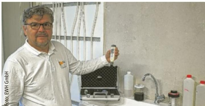
Getestet werden pH-Wert, Wasserhärte und die elektrische Leitfähigkeit.
