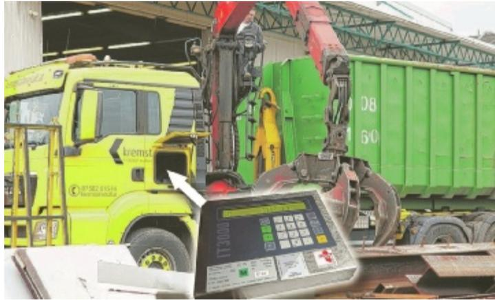
Die Lkw sind mit geeichten Wiegesystemen ausgestattet, mit denen jede Ladung Schrott unmittelbar vor Ort gewogen wird.
