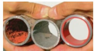
Sancor reinigt und saniert alte Rohre und Leitungen schonend. Foto: Sancor GmbH
