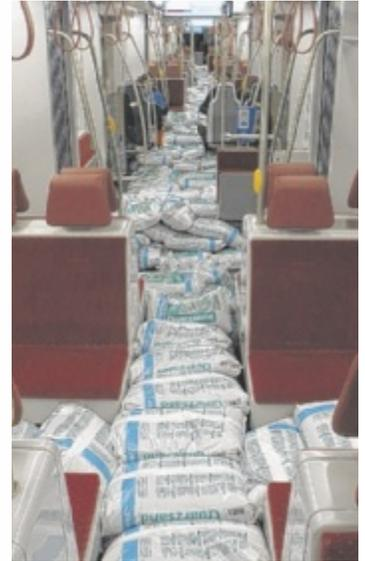
Mit 17 Tonnen Sandsäcken wurde das Bremsverhalten der Bahn getestet.
