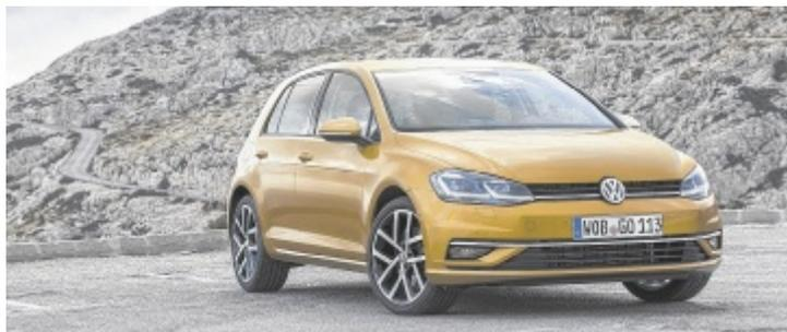
Zu den Design-Modifikationen gehören neue Stoßfänger vorn und hinten, neue Halogenscheinwerfer mit LED-Tagfahrlicht sowie neue Voll-LED- statt Xenon-Scheinwerfer. Werksfoto
