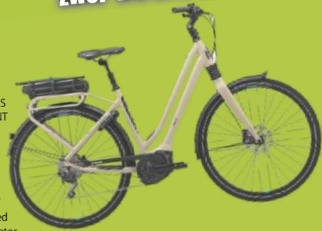
E-Bike GIANT PRIME E+ 2 LDS 2017 / Größe: S oder M / Rahmen: GIANT Prime E+ AluX Aluminium für SyncDrive Mittelmotor / Schaltwerk: Shimano Deore Dyna-Sys Shadow M610 / Motor: GIANT SyncDrive Life powered by Yamaha Mittelmotor, 250 W, 60 Nm / Akku: GIANT EnergyPak 400 Lithium-Ionen Akku, 36 V, abschließbar / uvm.
