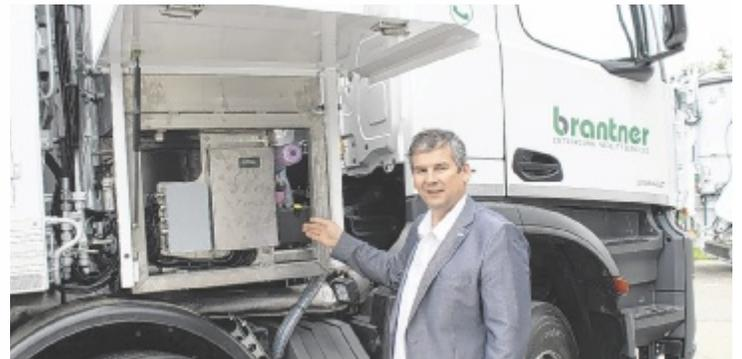
Brantner-Geschäftsleiter Otto Burger zeigt die innovative Waschanlage des neuen Müllfahrzeugs. Der Tank fasst 2700 Liter Wasser, was zur Reinigung von rund 600 Biotonnen reicht. Auch eine Desinfektion der Tonnen ist möglich. Die Mitarbeiter kommen mit der Wassermenge den ganzen Tag aus. Fotos: Brandt
