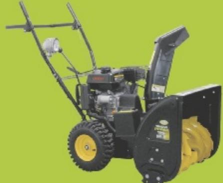
**Polar Snow Power 65/56 E Schneefräse:** Auswurfkamin mit verstellbarer Auswurfklappe, beidseitige ein- / und ausschaltbare Radsperre, verstellbare Gleitkufen zum Einstellen der richtigen Höhe, 4-Kantauswurf - verhindert das Festsetzen von Schnee, gezahnte Frässhnecke durch Scherbolzen gesichert, separate Einschaltung von Fräswerk und Antrieb, 3-Blatt Gebläsead, 2-Stufen Frässystem, Elektrostart für einfaches und leichtes Starten.
