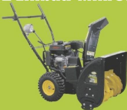
**Polar Snow Power 65/56 E Schneefräse:** Auswurfkamin mit verstellbarer Auswurfklappe, beidseitige ein- / und ausschaltbare Radsperr, verstellbare Gleitkufen zum Einstellen der richtigen Höhe, 4-Kantauswurf - verhindert das Festsetzen von Schnee, gezahnte Frässhnecke durch Scherbolzen gesichert, separate Einschaltung von Fräswerk und Antrieb, 3-Blatt Gebläsead, 2-Stufen Frässystem, Elektrostart für einfaches und leichtes Starten.**Anbieter & Gewährleistungspflicht:**Staudinger Bau GmbH
