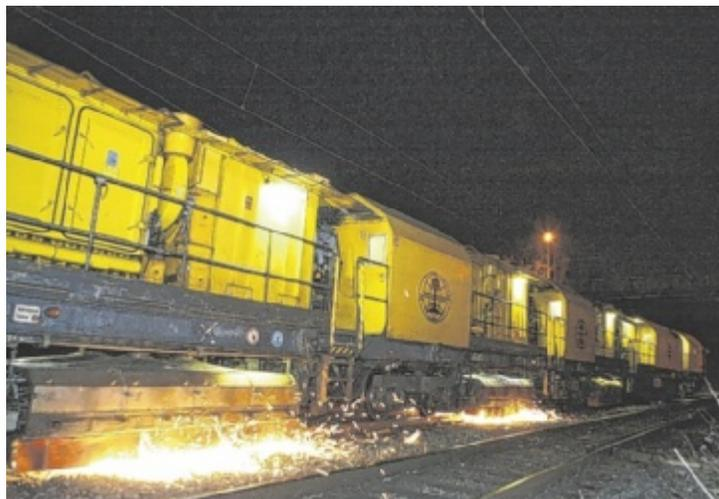
Mit 2.500 PS geht der Schienenschleifzug ans Werk.
