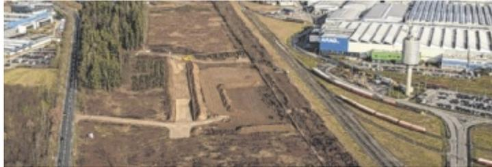
Sickerbecken und Sickermulden am Werksgelände der Amag tragen zu Erhalt des natürlichen Wasserkreislaufs bei.
