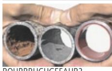
**ROHRBRUCHGEFAHR? ROST IM WASSER? DRUCKVERLUST?** Sanierte Rohrleitungen ohne Aufstemmen der Wände
