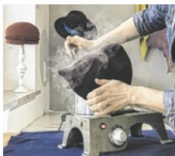
Der heiß gedampfte Hut wird am Hutdehner gedehnt, bevor er auf eine Holzform gespannt wird (l.). Die Krempe wird auf die Holzform aufgezogen (r.).
